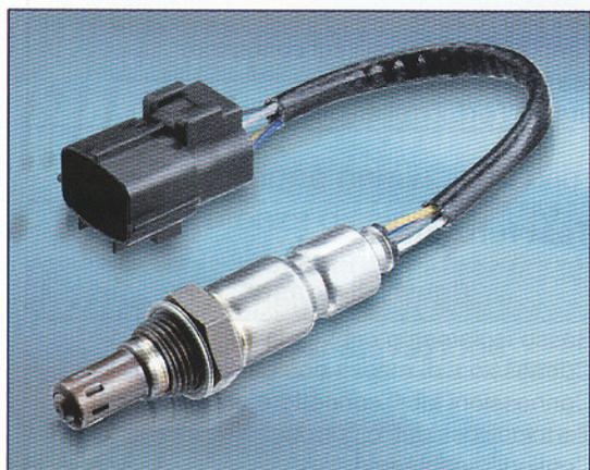
Per la prima volta, su questo sensore, il riscaldatore in ceramica e l'elemento sensibile ceramico sono assemblati assieme per ridurre al minimo la dispersione termica in modo da rendere operativa la cella di misurazione nel minimo tempo possibile. Difatti la temperatura di misurazione dell'elemento sensibile viene raggiunta in soli 5 secondi rispetto ai 15 dei sensori della precedente generazione. Le
