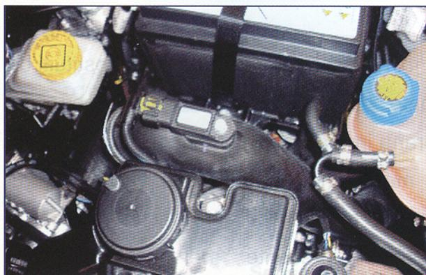
Sensore pressione di sovralimentazione
