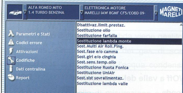
La sostituzione della sonda lambda a monte del catalizzatore richiede la successiva esecuzione della specifica procedura, grazie alla quale vengono cancellati dalla memoria della ECU motore i parametri adattativi appresi durante l'utilizzo del motore.
