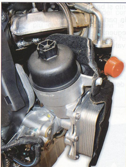
L'impianto di lubrificazione delle motorizzazioni MultiAir, in sostituzione della cartuccia olio motore, è dotato di un sistema integrato filtro olio denominato Green Filter. Il sistema è costituito da:
