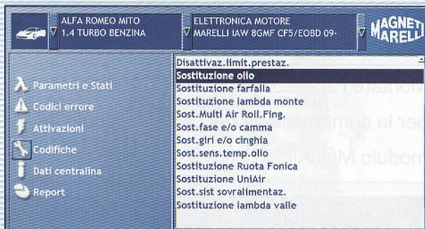
La sostituzione del lubrificante motore deve essere seguita dall'esecuzione della **procedura di sostituzione**. In questo modo vengono azzerati i parametri adattativi del modulo MultiAir memorizzati dalla centralina controllo motore.
