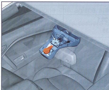
Il sensore di pioggia gestisce il funzionamento automatico dei tergicristalli nel funzionamento in modalità automatica, si tratta di un sensore a led infrarossi installato sul parabrezza della vettura in grado di rilevare la presenza della pioggia. Il suo segnale, ricevuto su linea A-BUS, permette al Body Computer di regolare la frequenza di battuta delle spazzole tergivetro.
