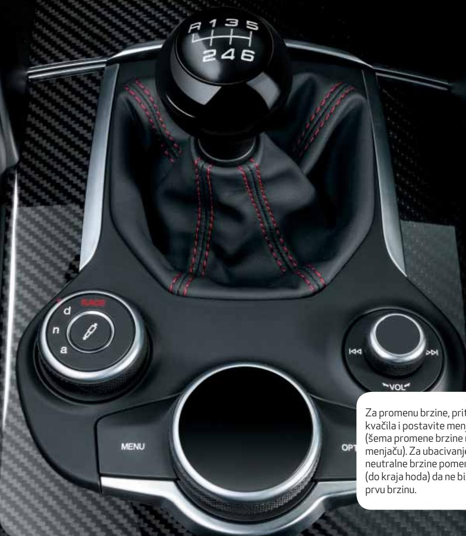
Za promenu brzine, pritisnite do kraja papučicu kvačila i postavite menjač u željeni položaj (šema promene brzine nalazi se na samom menjaču). Za ubacivanje u rikverc R sa položaja neutralne brzine pomerite ručiću nalevo (do kraja hoda) da ne biste greškom ubacili u prvu brzinu.
