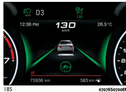
Odvajanjem ruku od volana, sistem se ne deaktivira automatski nego posle nekoliko sekundi. Na displeju će se prikazati niz namenskih prikaza i emitovaće se zvučni signali koji će upozoriti vozača na potrebu vraćanja
