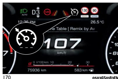
Uređaj se ne može aktivirati u prvoj brzini ili u rikvercu: preporučuje se aktivacija u trećoj i većim brzinama.
