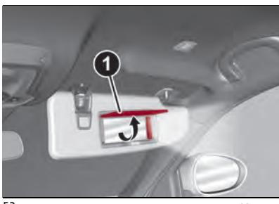
Svetlo na plafonu se automatski pali kada se podigne poklopac (1).
