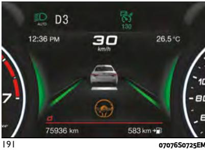
Nakon što prođe nekoliko sekundi a da vozač još nije stavio ruke na volan, na displeju instrument table prikazaće se sledeći prikaz sl. 192.
