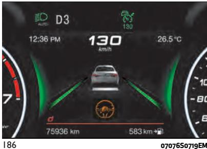
Nakon što prođe nekoliko sekundi a da vozač još nije stavio ruke na volan, na displeju instrument table prikazaće se sledeći prikaz sl. 187.
