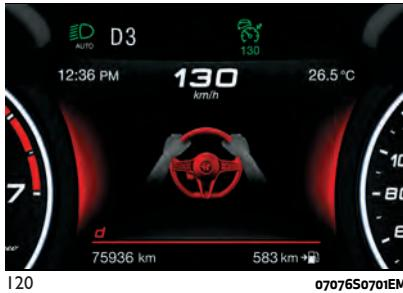
U tom slučaju emitovaće se zvučni signal. Ako se ruke vozača ne nalaze na volanu nakon dužeg vremenskog perioda, na displeju instrument table prikazaće se poruka o deaktiviranju. Nakon toga će se kontrola volana deaktivirati.
