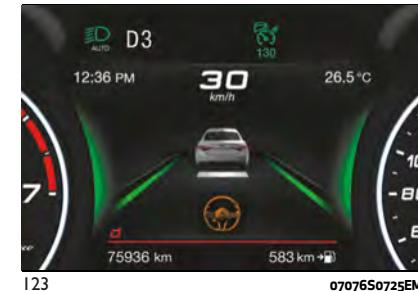
Skidanjem ruku sa volana sistem se neće deaktivirati automatski, već nakon nekoliko sekundi: na displeju instrument table pojaviće se, u nizu, namenski prikazi na ekranu, kako bi se vozač upozorio da vrati ruke na volan (pogledajte opis u nastavku).
