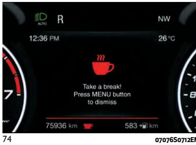
□ Ako vozač **prihvati** predlog koji je dobio od sistema, pritiskom na dugme MENU smešteno na desnoj ručici na volanu i zaustavi se da uzme pauzu, poruka će nestati sa displeja i ostaće prikazan simbol ☕ u odgovarajućoj oblasti displeja instrument table sl. 75 sve do sledećeg isključivanja/ponovnog pokretanja motora.
