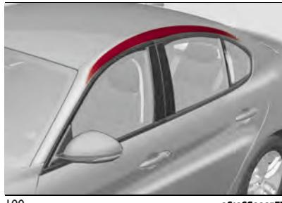
U slučaju blažeg bočnog udarca, ne aktiviraju se bočni zaštitni jastuci.
