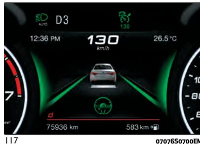
Odvajanjem ruku od volana, sistem se ne deaktivira automatski nego posle nekoliko sekundi. Na displeju će se prikazati niz namenskih prikaza i emitovaće se zvučni signali koji će upozoriti vozača na potrebu vraćanja ruku na volan (pogledajte opis u nastavku).
