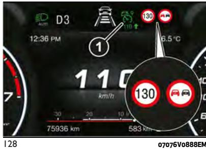
**UPOZORENJE** Biranjem stavke "Speed Offset" moguće je podesiti povećanje brzine na koje će se regulisati sistem ISC sve do maksimalnih 10 km/h iznad ograničenja na saobraćajnom znaku koji je sistem detektovao, ili smanjenje brzine na koju će se regulisati sistem ISC do maksimalnih 10 km/h ispod ograničenja na saobraćajnom znaku koji je detektovao sistem. U tim slučajevima, informacija na saobraćajnim znakovima prikazana na displeju instrument table ostaće ona koju je detektovao sistem TSR.
