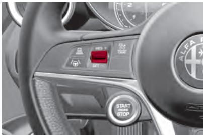
Dok je pritisnuta papučica gasa uređaj neće biti u stanju da kontroliše rastojanje između vašeg vozila i vozila ispred. U ovom slučaju brzina će biti određena samo položajem papučice gasa.
