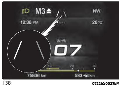
Kada sistem detektuje da se vozilo približilo liniji trake i hoće da je pređe, leva linija na displeju instrument table se osvetljava žutom i crvenom bojom, sl. 139.
